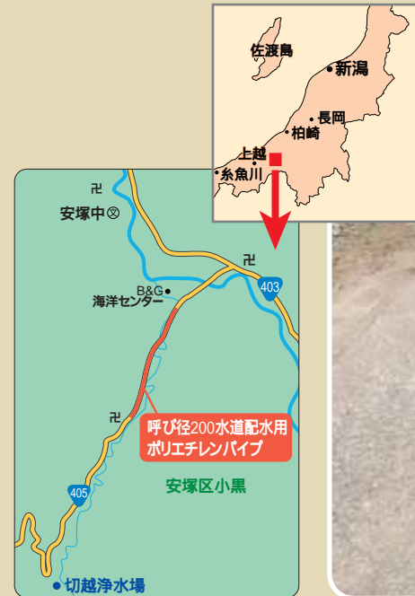
平成21年度呼び径200布設替え区間
