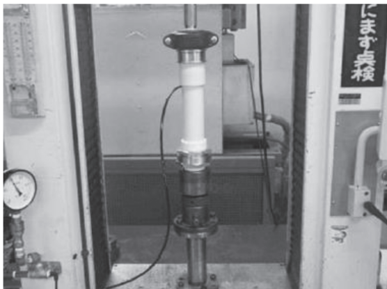
写真2 引張破壊試験状況
