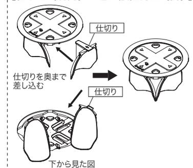
❗ 汚水が越流しますので仕切りが必要な箇所には必ず設置してください。
