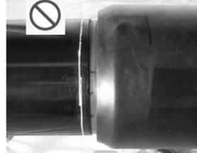
管の挿入不足や外層の除去範囲が大きい場合、内管がむき出しになります。一部でも内管が露出しないように、施工手順を順守して下さい。
