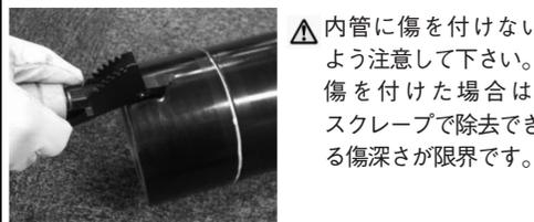
△ 内管に傷を付けないよう注意して下さい。傷を付けた場合は、スクレープで除去できる傷深さが限界です。
