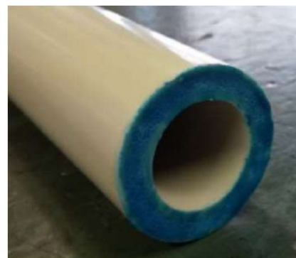
パイプ端面の接着剤塗布状況
