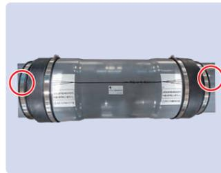
マイナスドライバーを使用し、写真赤丸部のSUSバンドを手締めで目一杯締付けて管を固定する。
