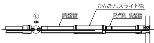
⑥ 調整管を設置、さや管（起点側と調整管）を接合する。
