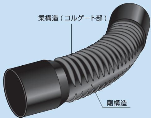
曲管部はコルゲート部を有しており、柔構造・剛構造を両立させています。
