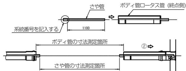
② ローラス管（終点側）にさや管（短管）を挿入後、ローラス管（終点側）をダクトスリーブに接合する。
