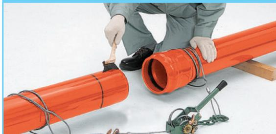
受口内面ゴム輪部、差口外面の順に、塗りムラのないよう円周方向に均一にVソープを塗布します。この時、差口は管端から標線まで全円周にわたって塗布してください。
