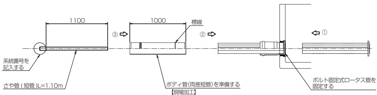
① 終点側のボルト固定式ロータス管をセットする。
