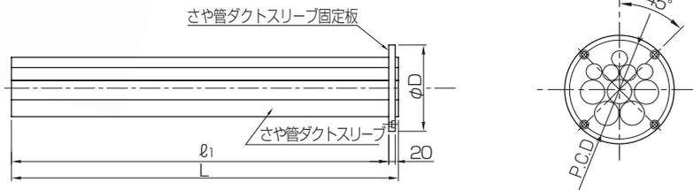
※ 図面の形状はロータス管φ200(φ50×5条/φ30×5条)です。
