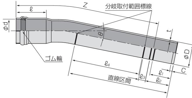
※分岐管を取付ける直線部を持った曲管です。
