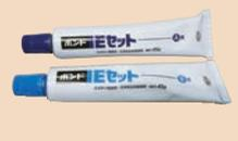
粘液状・二液性 | A 剤：55g<br>B 剤：45g                                          | 異種管用<br>(鋼管、FRP、PFP)<br>との接合用  | メーカー<br>規格品 | 可使時間:90分以内<br>(20℃)、<br>硬化時間:約10時間<br>(20℃)                                                |
