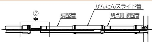
⑦ ボディ管（起点側と調整管）を接合する。
