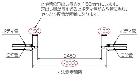
さや管の飛び出し長さを 150mm にします。
