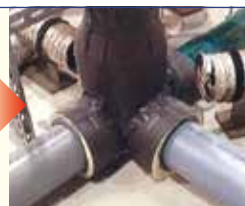
試験後の非加熱側の状況
