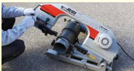
④ バンドソー、または手のこを用いて、管軸に対して直角に切断します。 ※プレ遮音シートと本体は別々に切断してください。
