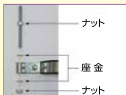
③ VCLベンド支持金具両端のボルト通し穴に、①の全ねじボルトを通し、ベンド本体を吊り下げ、設置レベルを調整します。
