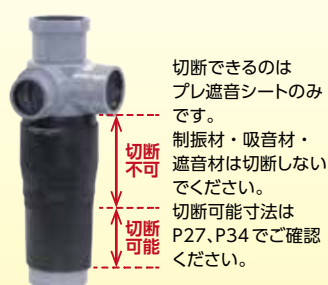
③ 下部差し口に切断線を記入します。
