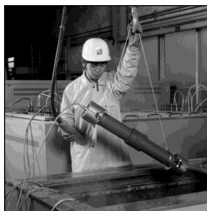
内圧クリープ試験（試験風景）
