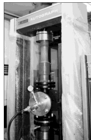
引張水圧試験：最大荷重発生時（降伏時）直後
