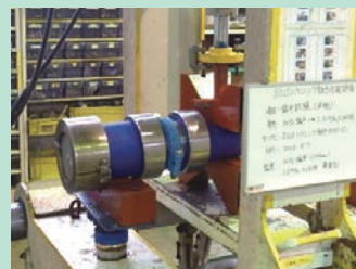
へん平水圧試験 呼び径 150、 30% へん平状況
