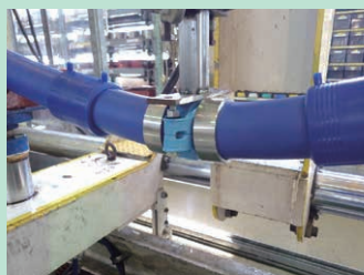
曲げ水圧試験 呼び径 75、 30°曲げ状況
