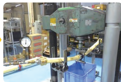
曲げ破壊試験
