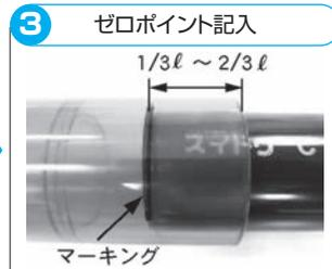
接着剤を塗布せずに管を継手に挿入します。継手端面から管端面までの長さが $1/3 \ell \sim 2/3 \ell$ であることを確認して継手表面にゼロポイントをマーキングします。
