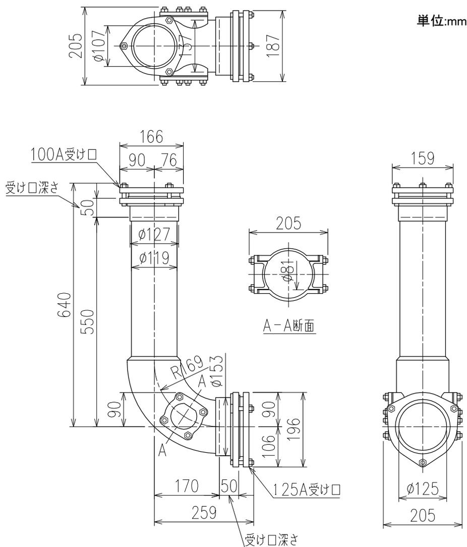
・鋼管サイズにはRJ鋳鉄管・ストレート排水鋳鉄管・鋼管・VP管が、鋳鉄管サイズにはメカニカル形1種管が該当します。
