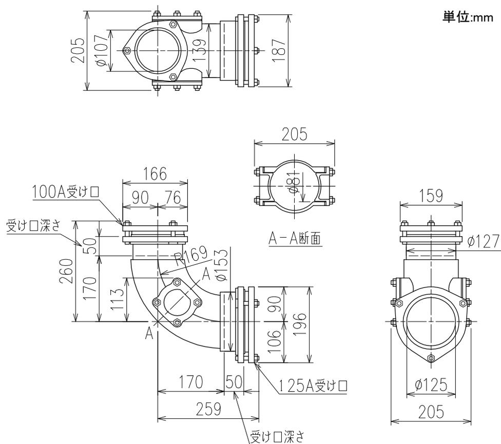
・鋼管サイズにはRJ鋳鉄管・ストレート排水鋳鉄管・鋼管・VP管が、鋳鉄管サイズにはメカニカル形1種管が該当します。
