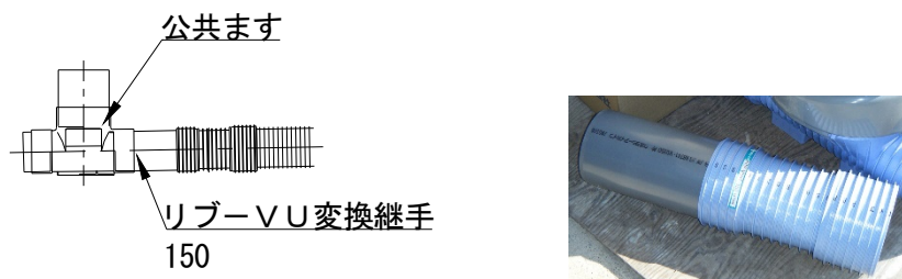
図 5-3. リブ-VU 変換継手使用例
