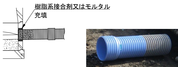
図 5-2. リブ上流用 MH 継手使用例
