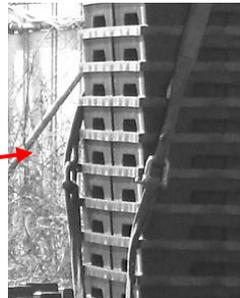
スリング 3m×3本をシャックル 2個で連結し、全長 9m のスリング 2本で荷降ろしする。
