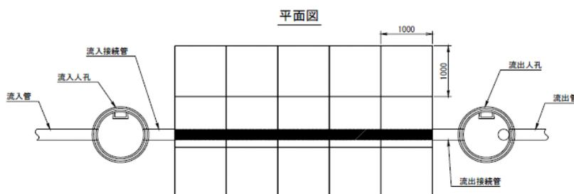
図-19 流入・流出人孔の設置例
