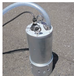
最大揚程12mソーラーポンプ 12m高さでの吐出量は4ℓ/min
