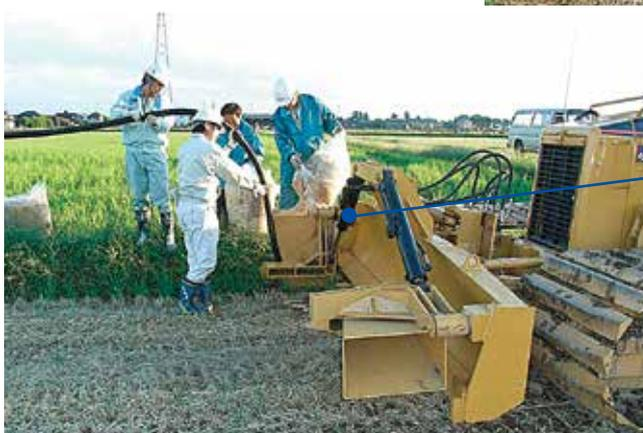
機械を反転させずに済むよう、左右にモミガラ投入用ホッパーを設置。
