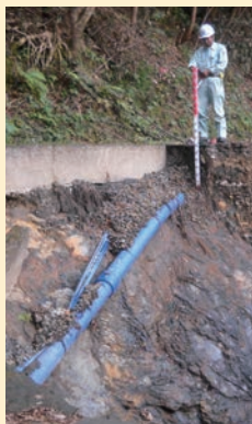
水道配水用ポリエチレン管は、 大きな地盤変状でも通水機能を 維持します。
