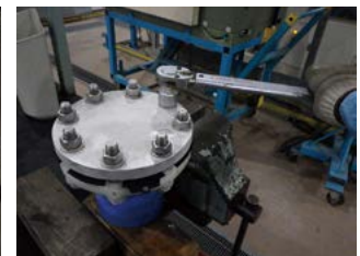
低温下でのボルト締め付けテスト
