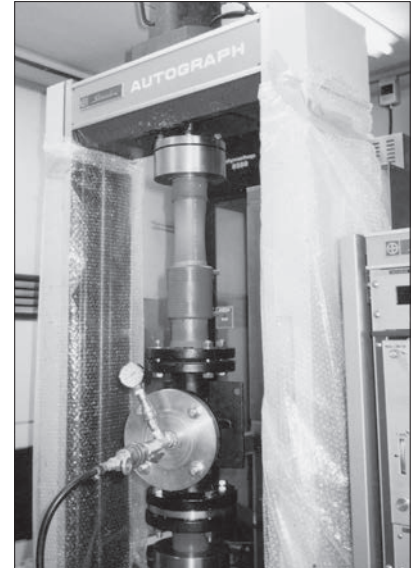
引張水圧試験：最大荷重発生時(降伏時)直後
