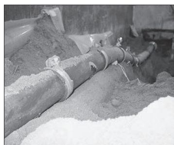
50cm沈下時の管路変形状況
