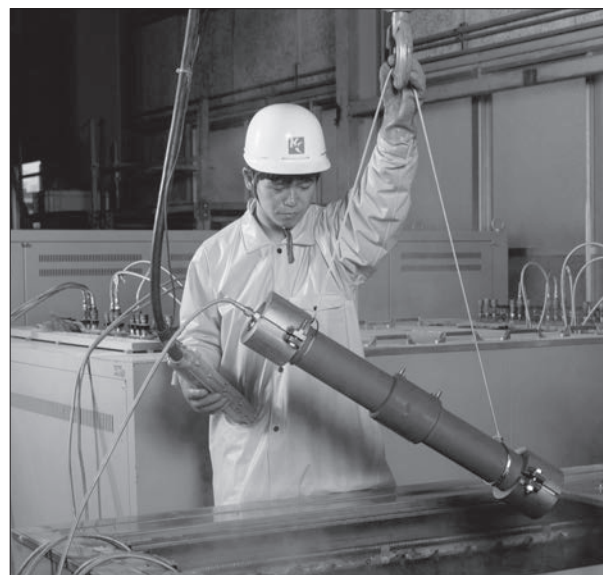
内圧クリープ試験(試験風景)
