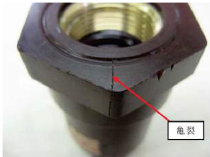
HTメタル入り給水せん用ソケットの破損事例
