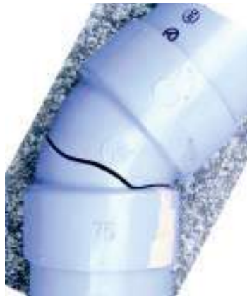
継手部の破損事例
