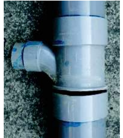
継手部の破損事例
