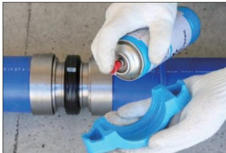
⑥ハウジングを溝に合わせて取付け、ナットを均等に規定量締め込みます。
