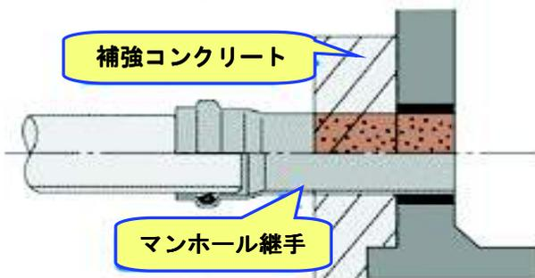
面仕上げ (Rカット) は、マンホール継手に過大な外力が加わらない状態で行ってください。
