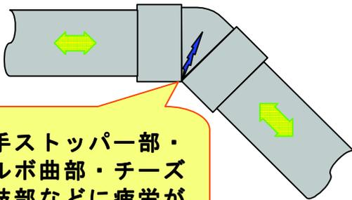
継手ストッパー部・エルボ曲部・チーズ分岐部などに疲労が進む。
