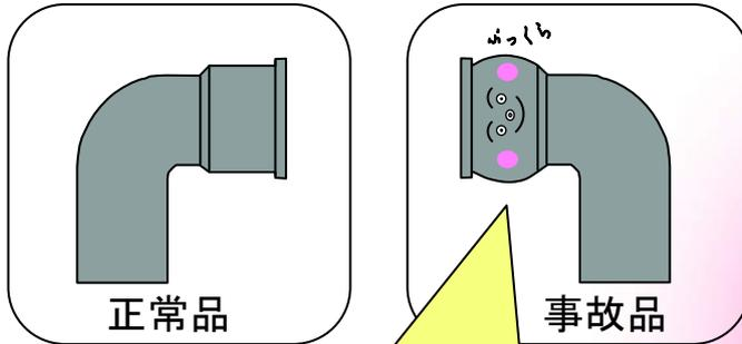
継手のねじ部を覆う塩ビ部分が膨らみ塩ビ部とねじ部に隙間が生じ漏水。
