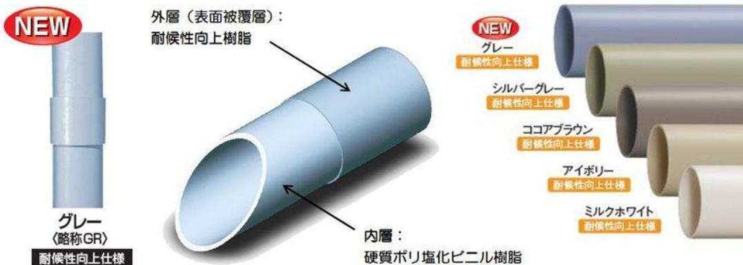
「タフカラーパイプ (グレー)」は、管の外層 (表面被覆層) に耐候性向上樹脂を使用した二層構造の「耐候性向上仕様硬質ポリ塩化ビニル管」です。硬質ポリ塩化ビニル管とほぼ同色のグレーのパイプですが、日光・熱・水などの自然環境による管外面の変色 (やけ、チョーキングなど) が進行しにくいという大きな特長を有しています。
