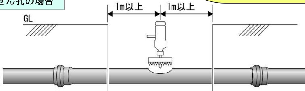
注. 掘削は、せん孔部を中心に本管軸方向に左右1m以上とする。
