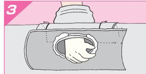
支管突出し部と本管穿孔部のすきまにKCケーシーボンドⅡを充填し、裏面を丁寧に仕上げます。
