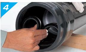
装着後、ゴム輪がゴム輪溝へ確実に装着されているかどうか確認してください。
