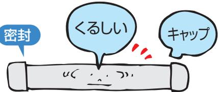
⚠️ 管路の末端部を密封せずに開放し、接着剤蒸気を排除してください。
