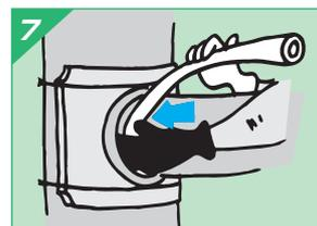
(くら型マンホール可とう継手のみ) ゴム部保護のため、ゴム部とくら突出し部の間にPEチューブを詰めます。
