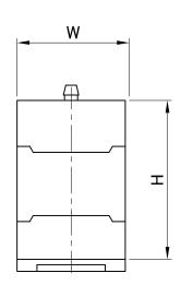
単位: mm 参考質量  $H\pm 2$ 対象品 呼び径×ピッチ  $A\pm 2$ D1 W (kg) 100 × 175P 175 115 75 87.5 0.2 130 × 175P 175 149 75 87.5 0.2
