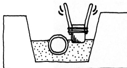
3. 管側部の基礎砂の巻出しは、一層の仕上がり厚さが30cmを超えないようにします。
