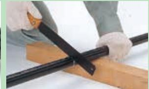
Potong pipa sepanjang garis potong pada sudut yang tepat ke sumbu membujur.
