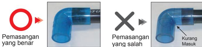
\*Catatan: Tergantung pada jenis fitting, ada kemungkinan sulit memasukan pipa sampai ke dalam 'stopper'. Pada kasus tersebut masukan pipa sampai posisi berikut; Zero point + Min. 1/3 l.
