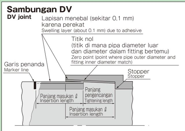
● Sebagian besar pipa PVC saluran air limbah dapat disambung menggunakan fitting DV.
